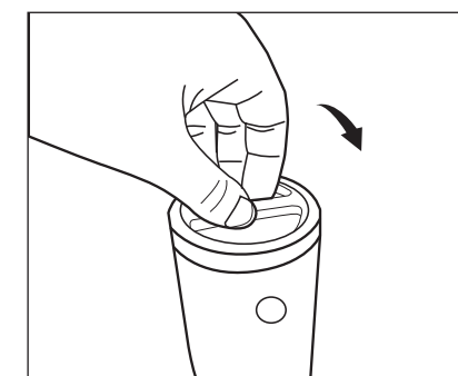
5. Quando le batterie sono state inserite, rimettere il coperchio allineando le frecce e ruotandolo fino a che la freccia punti verso il simbolo della serratura.
